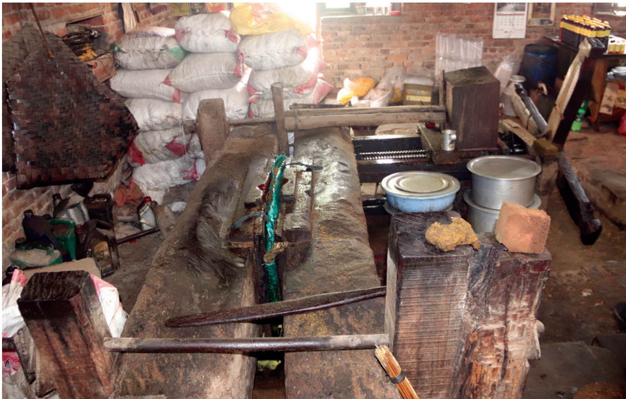
तोरी पेल्ले परम्परागत कालको कोल ललितपुरको खोकनामा रहेको परम्परागत तोरी पेल्ले काठको कोल। खोकना तोरीको तेलको लागि प्रख्यात छ। तस्विर: हरिराम भट्टवाल / रासल
